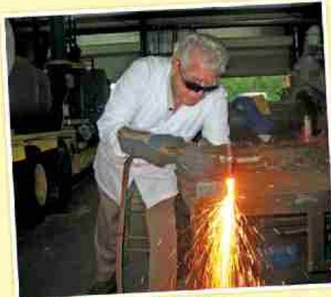
يستخدم الأكسجين مختلطاً مع الأستيلين في لحام المعادن.
